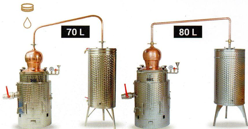
Kotel za kuhanje žganja iz bakrene in nerjaveče pločevine z dvojnimi dnom na vodo z izpustom 3C ali 4C in z lamelnim hladilnikom. Kurjava na trda goriva ali plin.
