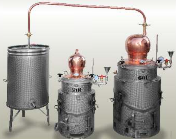
Kotel za kuhanje žganja iz bakrene in nerjaveče pločevine, z dvojnim dnom, na vodo
